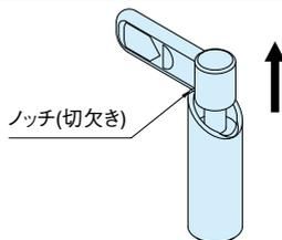
グリップは180°の位置で本体のノッチ(切欠き)におさまり、ノーズが引込んだ状態で確実にロック(固定)できます。ノッチから外すとノーズは内蔵スプリングによって元の状態に戻る、ハンド操作のインデックスプランジャーです。
