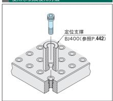
如果使用定位螺栓进行零件的定位,不仅可以起到 定位作用,还能起到紧固作用。
