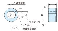
本体 SUJ2 淬火回火 四氧化三铁膜 精密研磨 HRC58~62
