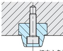
把内六角螺栓拧入安装孔里，拧紧，完成安装。
