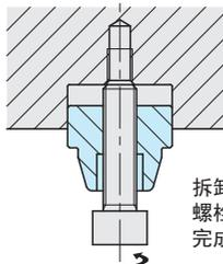
拆卸圆锥销产生困难时，请将螺栓拧入拆卸用螺孔，旋转，完成拆卸。
