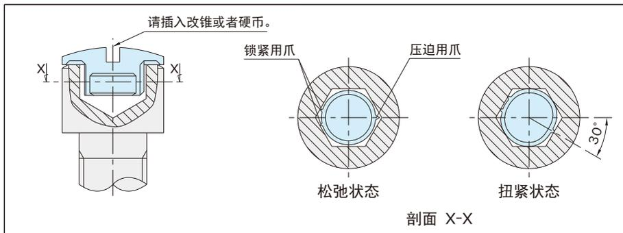
使用改锥或者硬币扭转30°后，3个爪压在六角孔的侧面，能生出强有力的保持力，盖子被牢牢锁紧。向反方向旋转就会松弛，能重复使用。
