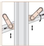
L6-AHJはスペーサーが付属されていますのでボ ルトで締付けてもプロファイルを任意の角度に 回転させる事ができます。
