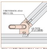
プロファイル端面に取付ける場合は、M6×1 深サ 15mm(加工品番 M6×15)のタップ穴加工を してください。又、付属のロケーターはT溝取付の 位置決めに有効です。
