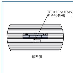
複数のTスライダーを使用した機構を構築する場合は、TSLIDE-NUTM6とTSLIDE-NUTM5を使用してTスライダーとプロファイルを固定してください。TSLIDE-NUTM6とTSLIDE-NUTM5を使用する事で公差を吸収して動きをスムーズにします。
